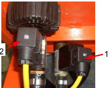
Реле давления подлежат замене, если участились случаи их неисправности. Реле давления имеют постоянную уставку, которая не может регулироваться.
