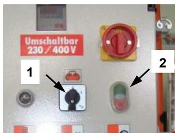
*Рис. 46: Включение воздушного компрессора*
