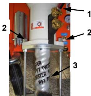
Рис. 62: Выньте блок насоса
