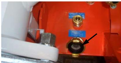
Рис. 80: Грязеулавливающий фильтр на входе воды
