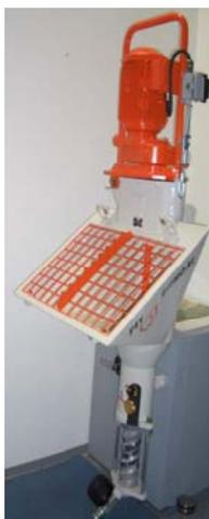
Рис. 8: Модуль контейнера материала
