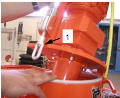
Рис. 60: Закрыть фланец наклона двигателя
