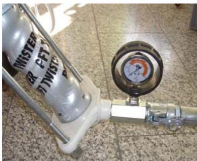
Рис. 39: Манометр давления раствора
