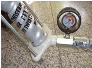
Рис. 73: Манометр давления раствора
