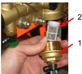
Рис. 81: Грязеулавливающая сетка
