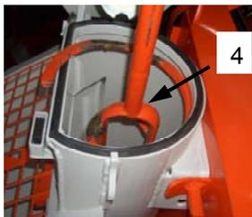
Рис. 57: Выемка смесительной спирали
