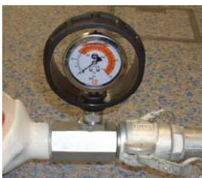
Fig. 23: Манометр давления раствора
