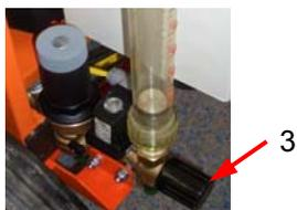
Рис. 82: Редукционный клапан
